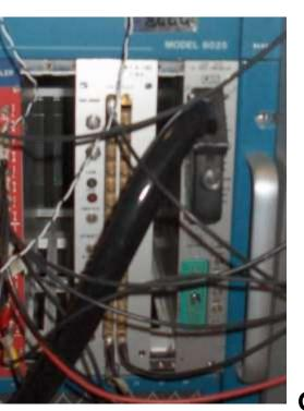
Ha permesso di sostituire un trigger fatto da alcuni crate nim ed alcuni moduli camac
