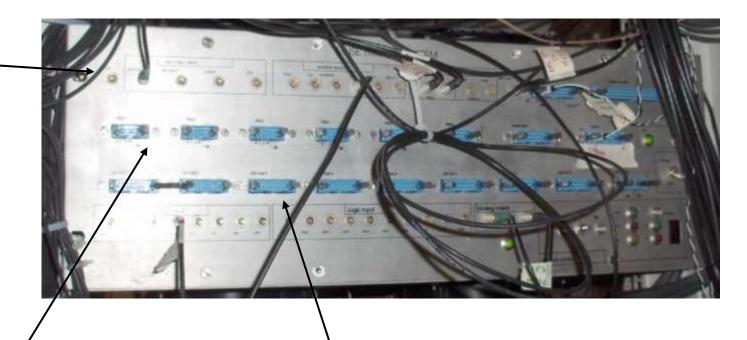
Era specializzato per la gestione di un sistema di readout basato su moduli FDL che avevano bisogno di un segnale TTL e di un pattern logico per fare partire il readout dei QDC Come tutti i moduli qualche lucetta accesa ti rassicura del fatto che ci sia la corrente
